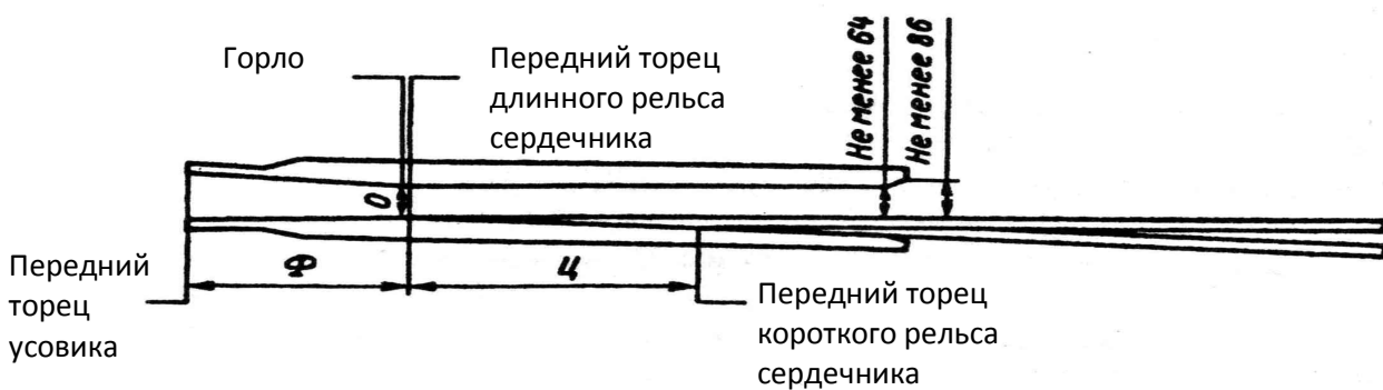
Рисунок 3.13. Места контрольных измерений ширины желобов и расстояний от переднего торца усовика до переднего торца длинного рельса сердечника ( \Phi ) и между торцами длинного и короткого рельса сердечника ( \mathcal{L} ) на крестовинах с подвижным сердечником (мм)
