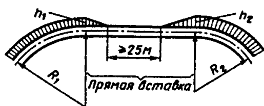
а) при сопряжении смежных кривых одного направления при достаточной длине прямой вставки.
