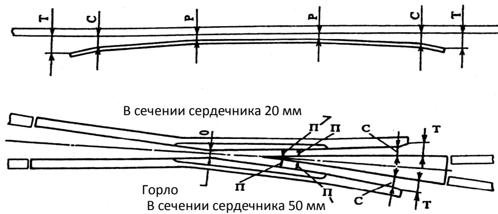
Рисунок 3.12. Места контрольных измерений ширины желобов в острых крестовинах и в контррельсах
